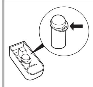
Лоток 4 для отбеливателя вставляется в отделение 1 распределителя моющих средств. Не заполняйте лоток 4 выше отметки max (см. рис.). Для осуществления только отбеливания налейте отбеливатель в дополнительную вставку 4, выберите программу "Полоскание" и задействуйте функцию "Отбеливание".
