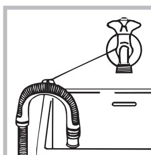
для сливного шланга, при необходимости допускается его наращивание шлангом такого же диаметра и длиной не более 150 см.
